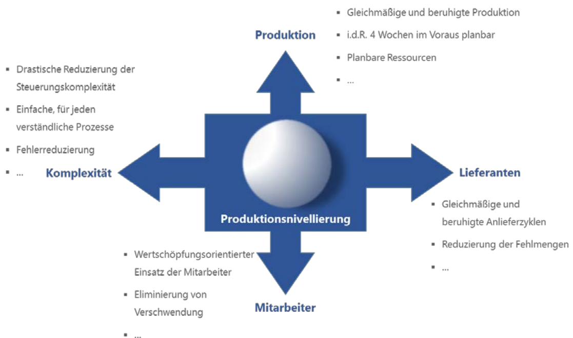
Abbildung 1: Wirkungsweise der Produktionsnivellierung
