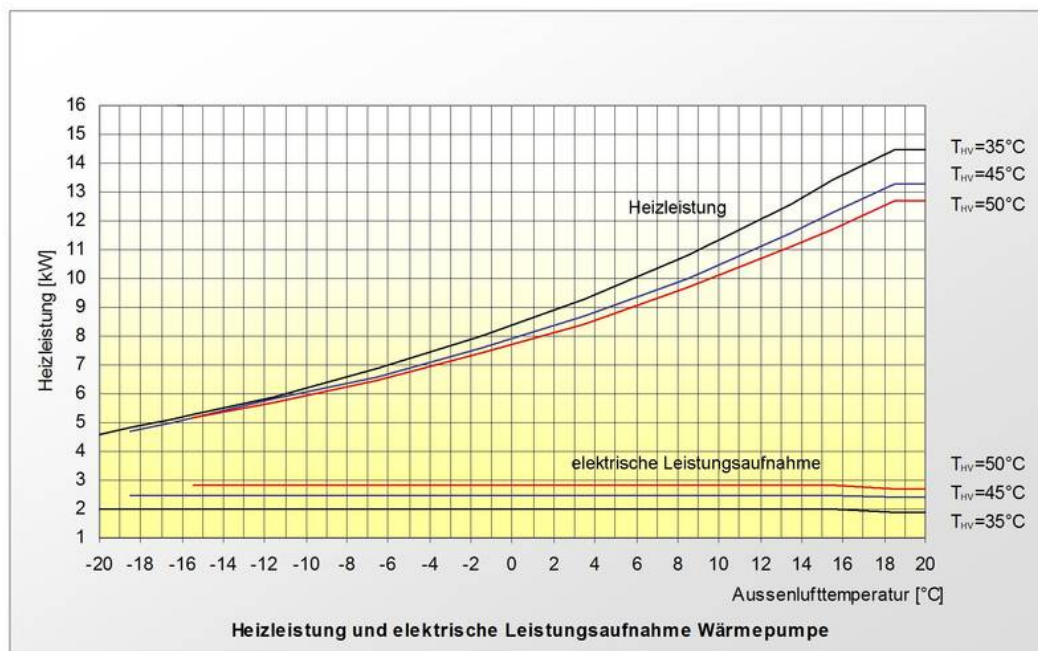
Abbildung 18: Kennlinienfeld einer Wärmepumpe [49]
